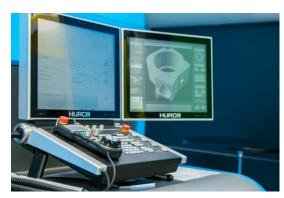
Die 5-Achs-Maschinen der VMX-Reihe sind mit der Dialogsteuerung "WinMax" – wahlweise mit DXF-Option – ausgestattet. Die leistungsstarke Software der Steuerung von HURCO vereinfacht
