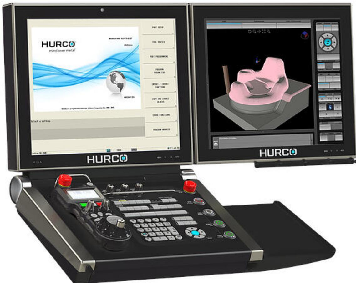
Bei der Option Solid Model-Import können Volumenkörper im STEP-Format direkt in der Steuerung eingelesen und zur Programmierung verwendet werden. Die Hinzuziehung externer Dienstleister zur Erzeugung von 2D-Zeichnungen mit Bemaßung entfällt damit. Dies hilft allen, die häufig Änderungswünsche in der laufenden Produktion erhalten. Auch Lohnfertiger, die stark einzelteilorientiert sind und ihre Daten in der Regel als Modell ohne Zeichnung mit Bemaßung erhalten, profitieren davon.
