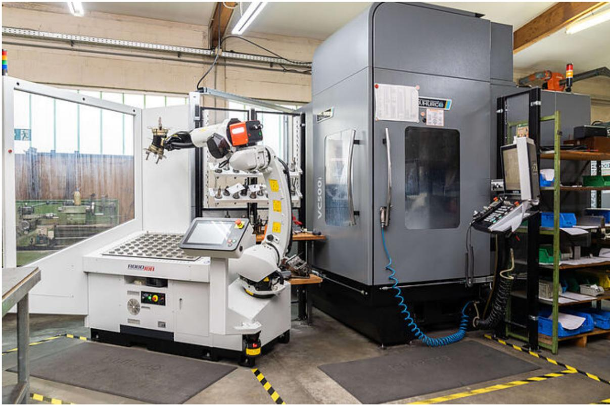
Dafür befüllen wir den Roboter mit zehn bis 80 Teilen, die dann von der Maschine abgearbeitet werden. In der Zwischenzeit kann sich der Mitarbeiter seiner Facharbeitertätigkeit widmen,“ berichtet Josef Schley. Schlussendlich kann die Maschine durch die Automatisierung – zusätzlich zu den besagten 50 Wochenstunden – weitere 20 bis 40 Wochenstunden arbeiten.
