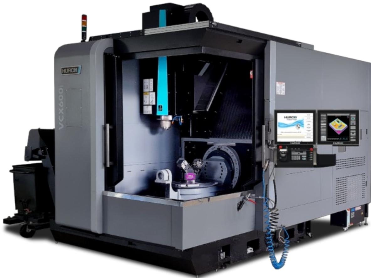
5-Achs-Bearbeitungszentrum von HURCO mit der CNC-Steuerung Max5
