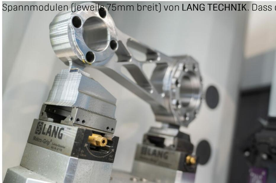
Spannmodulen (jeweils 75mm breit) von LANG TECHNIK. Dass damit sicher gespannt werden kann, ermöglicht eine Prägung an der unteren Rohteilkante, die einen Millimeter tief und 125 Millimeter breit ist. Gefertigt wird die Prägung mit einem Hydraulikwerkzeug, das die Zähne des Spannmoduls als Negativ in den Block presst. So entsteht beim Spannen ein enger Formschluss, der bei einer relativ kleinen
