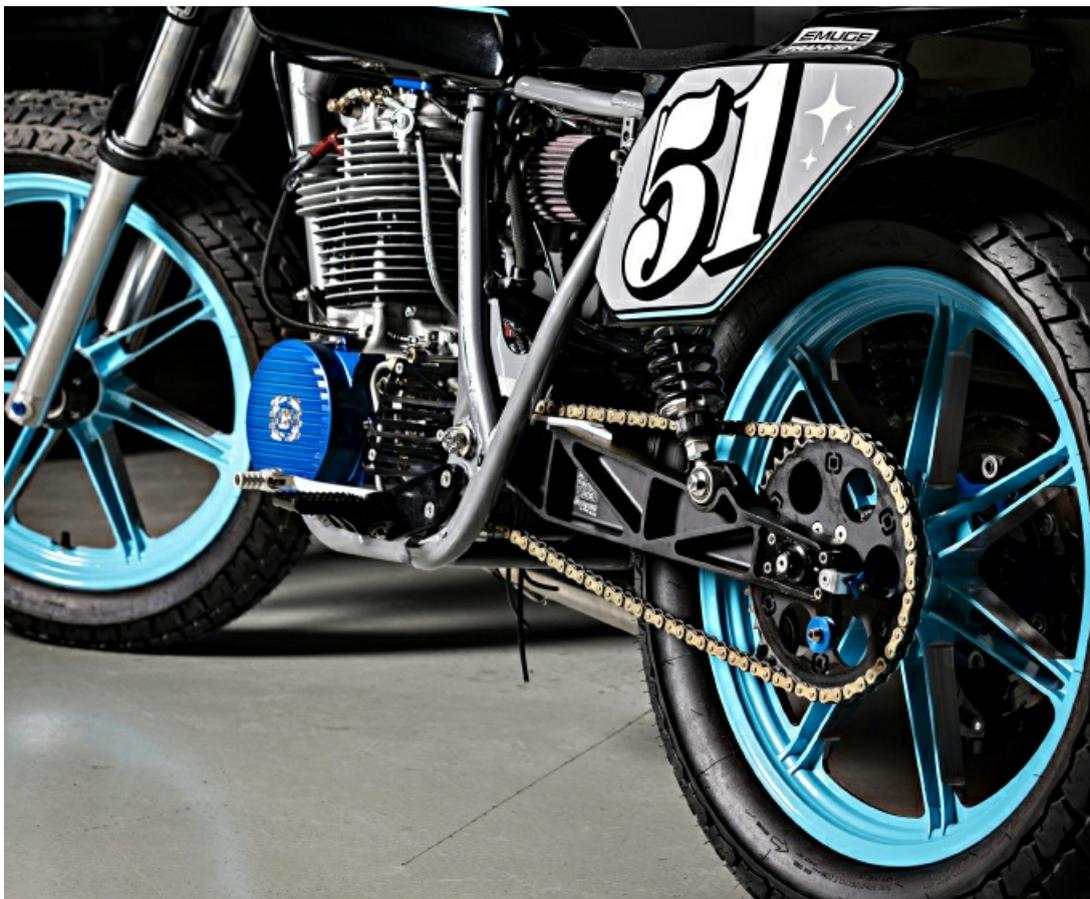
Hinten sind zwei neue Stoßdämpfer an einer speziell angefertigten Schwinge befestigt – ein Teil, das sich Maximes Chef gewünscht hat, um die Leistungsfähigkeit der Werkzeugmaschinen von HURCO zu demonstrieren. Die Schwinge wurde in Zusammenarbeit mit der CAD/CAM-Firma
