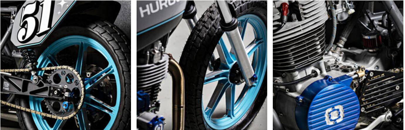
Vorne gibt es keine Bremse, dafür aber hinten einen Bremssattel und Hauptbremszylinder von Brembo, verbunden durch eine Leitung mit Edelstahlmantelung. Da Maxime das Motorrad von einer hinteren Trommelbremse umgerüstet hat, ist die gesamte Bremsanlage maßgefertigt – bis hin zur Bremssattelhalterung und den Fußschaltern.
